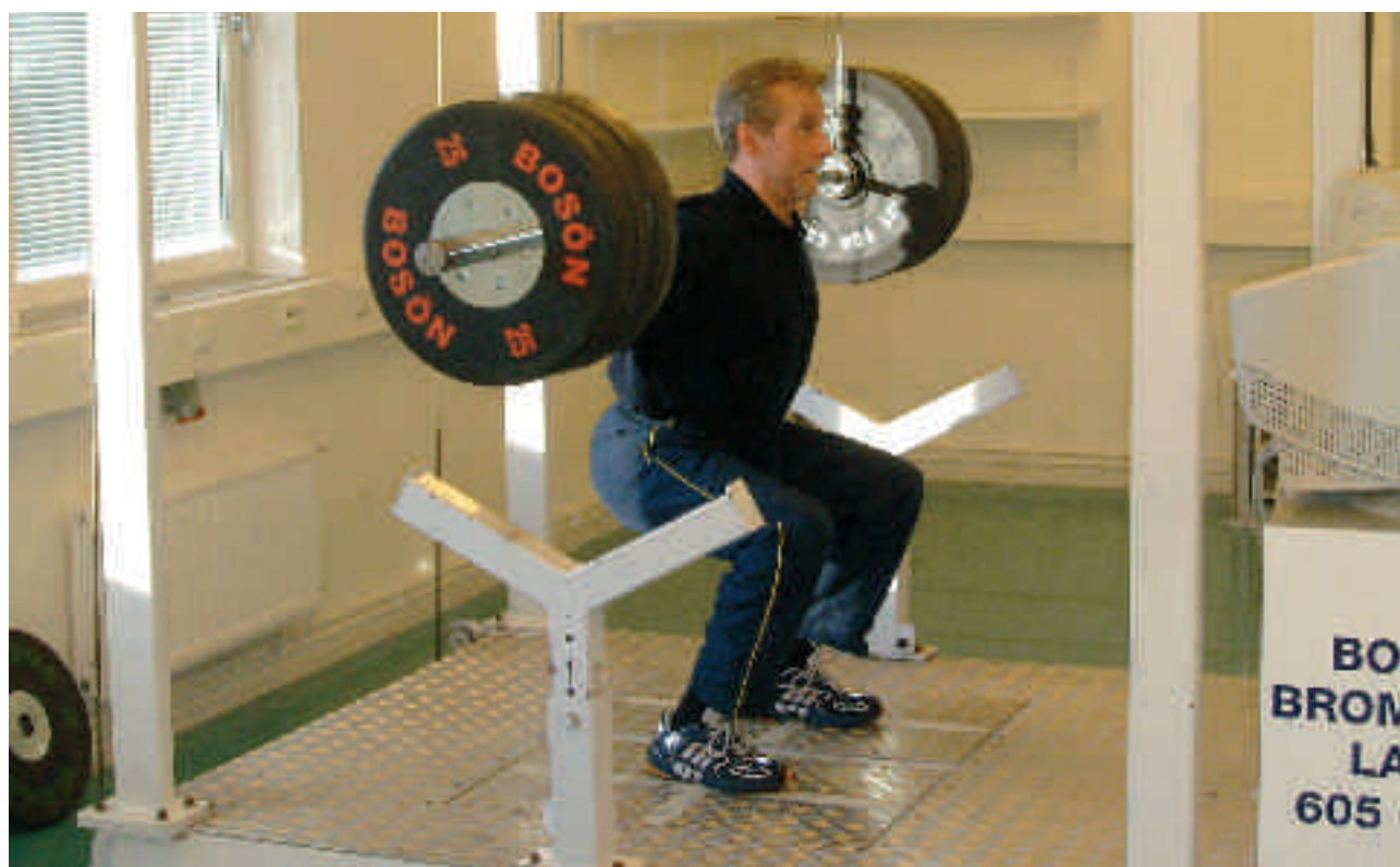
Den excentriska träningsmaskinen Broomsman har en viktig roll för utvecklingen av nya träningsmetoder. Utövaren kan hantera extremt tunga vikter på skivstång på ett säkert sätt.
